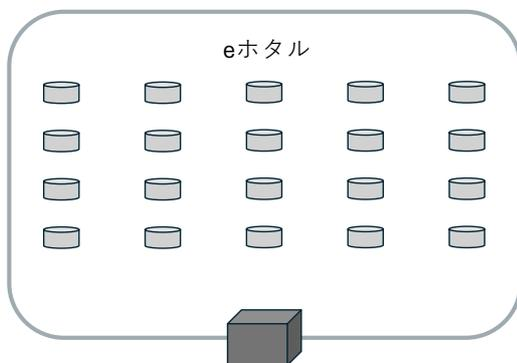
eホタル設置エリア外周にケーブル (全長400mまで) を敷設し、eホタルを制御します。
