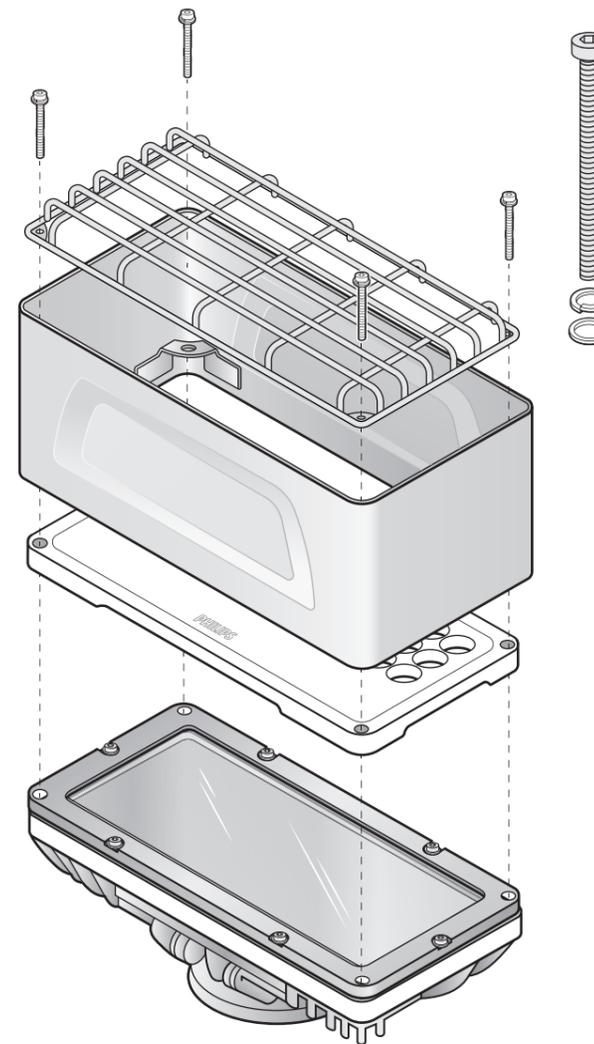
1. 取り付けるアクセサリーをすべて重ね合わせて、4本のネジでコーナーを締め付けます。
