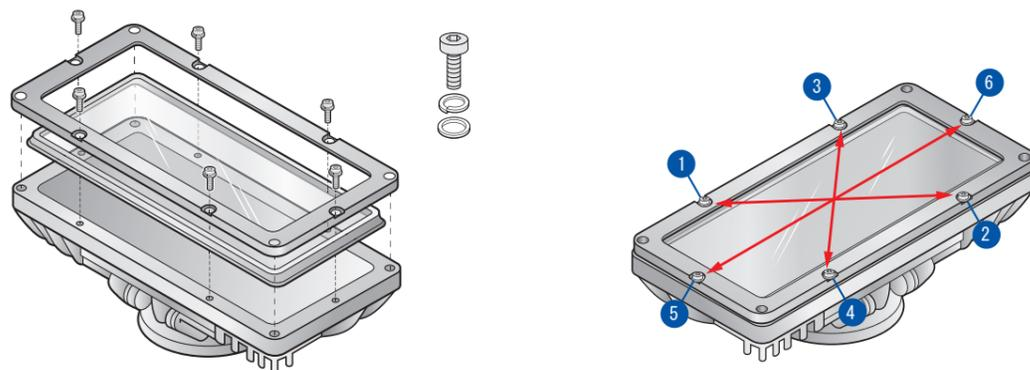
1. 拡散レンズとトリムリングを6本のネジ(12mm)を使用して本体に取り付けます。
