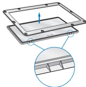
※拡散レンズのフレーム部分にあるツメが表になるように取り付けてください。
