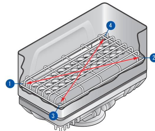
2. ネジ止め順序に従ってネジを締めてください。
