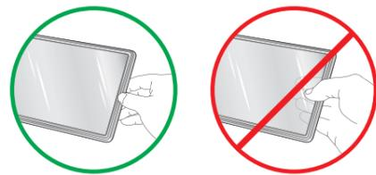
※拡散レンズを取り付ける際は、照射面に直接触らないでください。
