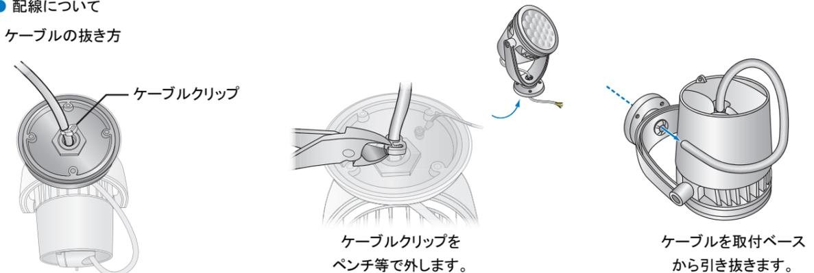
当製品は屋内・屋外両方で使用できますが、屋外で使用する場合は、アウトレットボックスなどを用い、防水処理を確実に行う必要があります。
