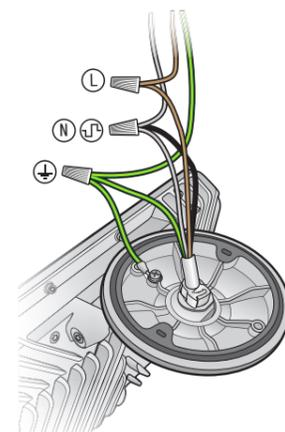
**7** 正しく配線されているか確認し、蓋を固定して下さい。
