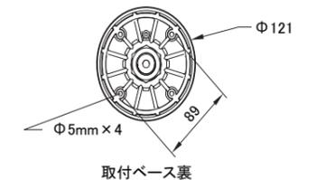
取付ベースには取付穴Φ5が4ヶ所設けてありますので、適用ビスで施工面にしっかり取り付けて下さい。取付が不十分の場合、器具の落下の原因になる事があります。
