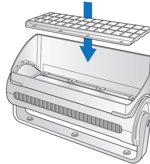
**5** ReachElite Powercore 本体上部に空いた8個のネジ穴に合わせて、ベゼル付き拡散レンズの上に、グレアシールド ハーフサイズ または グレアシールド フルサイズ を乗せます。
