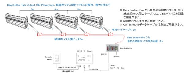
Data Enabler Pro 1台あたりのReachElite High Output 100 Powercore 最大接続台数 AC100V、結線ボックス間ピッチ5m・Data Enabler Pro から最初の結線ボックス間ピッチ10mの場合・・・8台(合計配線距離45m)
