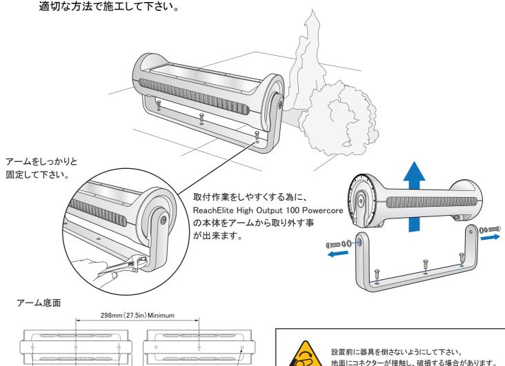
専用リードケーブルの接続作業がしやすいように、 ReachElite High Output 100 Powercore の本体と アームを固定するネジを、六角レンチ(8mm)を使っ て緩めます。
