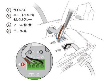
9 正しく配線されているか確認し、蓋を固定して下さい。
