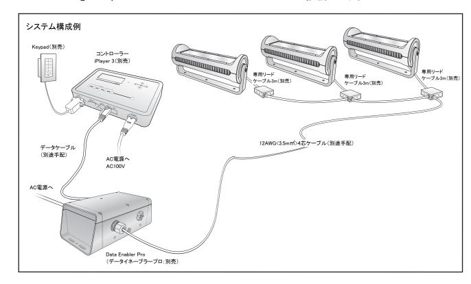
・専用リードケーブル(別売)と器具を接続します。 ※専用リードケーブルをカチッと音がして固定されるまで、しっかりと奥まで押し込んで下さい。
