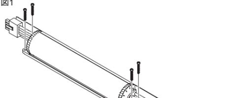
図1 灯具本体は90°に回転します。取付の際は適宜本体の角度を調整してビスを固定して下さい。
