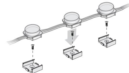
レールはプラスチック製ですのでニッパーなどで適切な長さに切ってください。レールは取付面の材質に適切なビスなどを使って固定します。目安として、少なくとも40cm間隔で固定してください。
